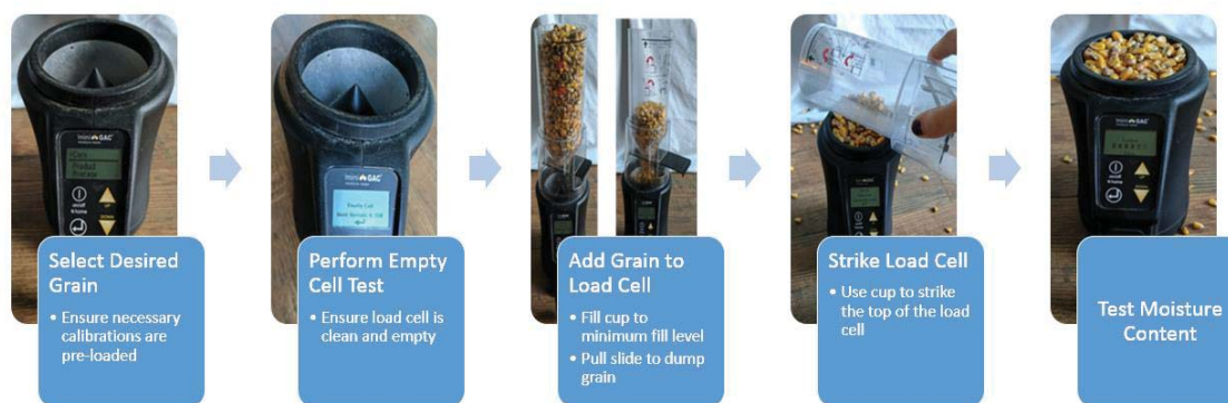
Figure 2.3-1: Mini GAC Moisture Tester Procedure
